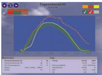
Tagesübersicht: Referenzwert des Einstrahlsensors (grün) mit Ertragskurve (gelb) und Modultemperatur (rot)
